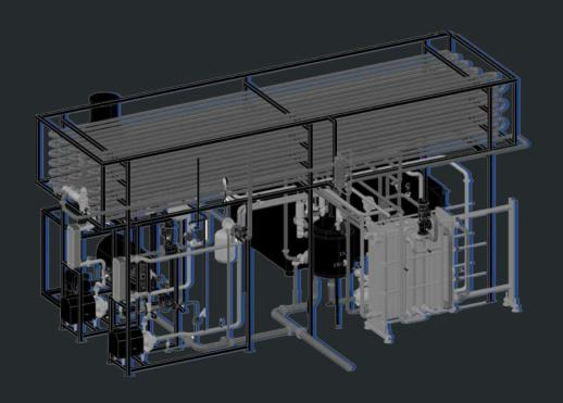
Оборудование предназначено для производства кисломолочных продуктов, сливок и смеси мороженого, при температуре +76...+80°С и охлаждения до температуры +3...+5°С.
